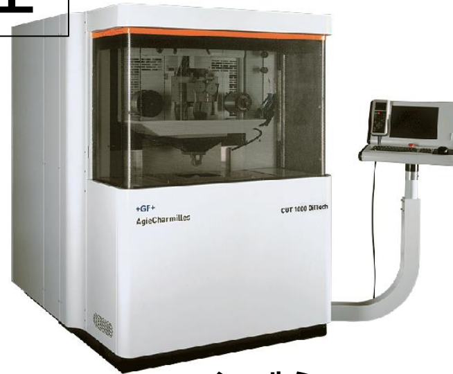
シャルミー Cut 1000 OilTech ワイヤー線径0.05 1台
