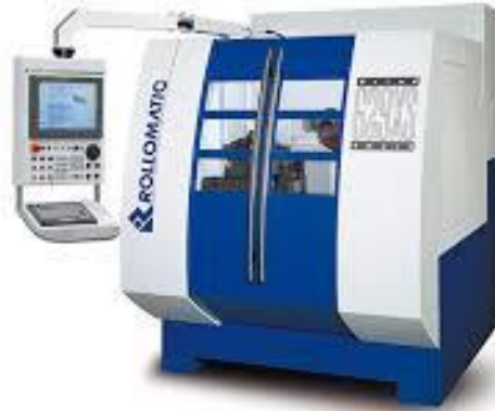
Rollomatic 629XS 1台 カッター/エンドミル加工機
